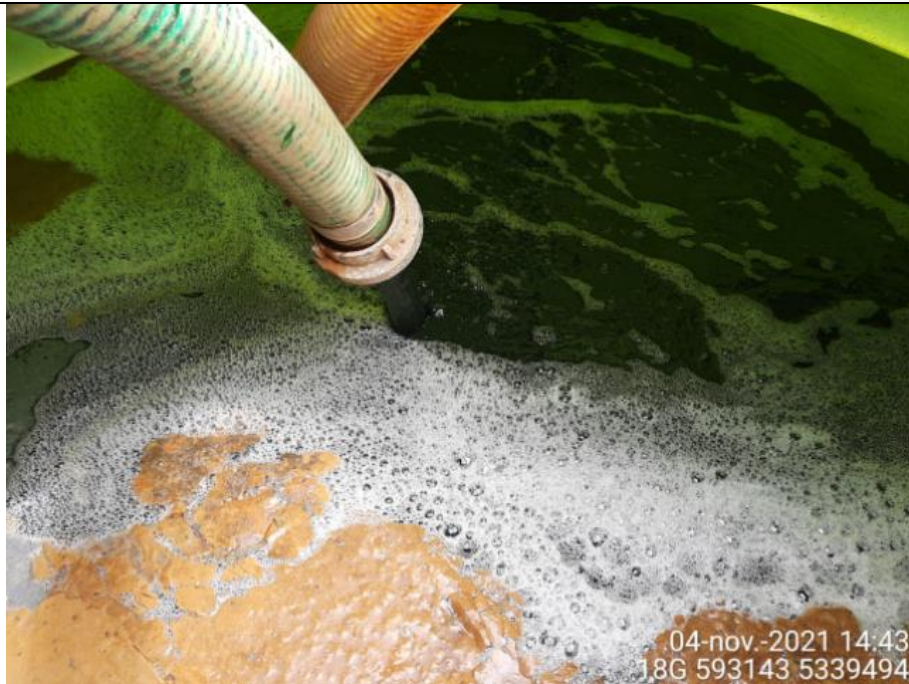
Fotografía N°6: Extracción de Lixiviados a estanque. Tomada: Jueves 04 de Noviembre del 2021.
